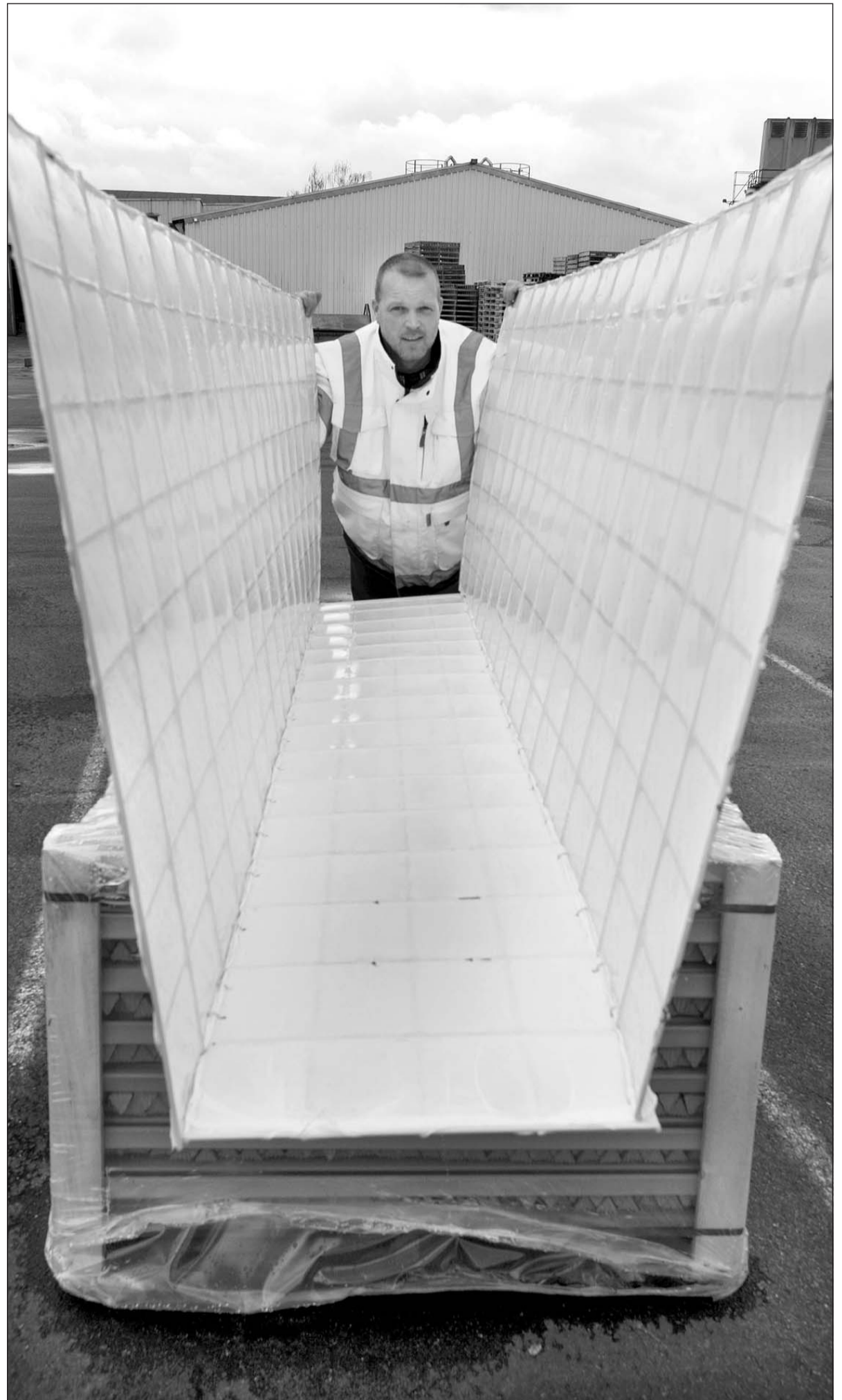
Frank Kettler von der Firma Reent Obernolte mit einem patentierten Ecofix-Element. Wo früher schweres Holz die Gebäudefundamente in Form brachte, zeigen heute leichte, mit Folie umspannte Stahlgittermatten dem Beton seine vom Bauarbeiter vorbestimmte Fließrichtung. Foto: Alexander Kröger
